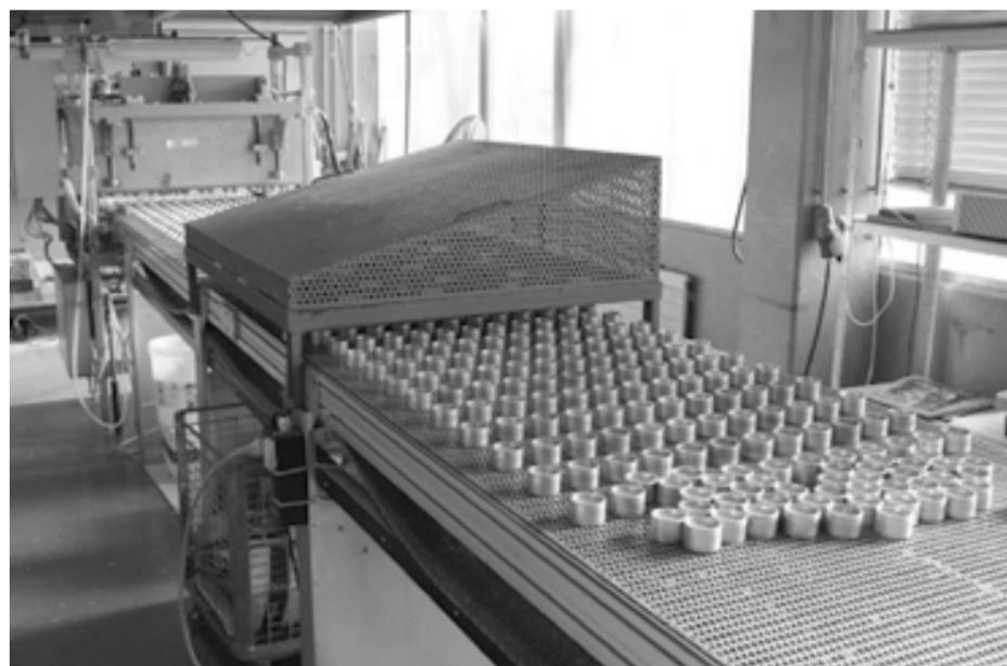
Eine halbautomatische Abfüllanlage ermöglicht uns eine Produktion von bis zu 8000 Teelichte am Tag. Wir verarbeiten unterschiedliche Rohstoffe wie Paraffin, Raps- und Bienenwachs. Sämtliche unserer Teelichte werden gegossen, von Hand ausgeformt und anschließend eingedochtet. Wir verzichten auf Aluhüllen und bieten Glas- sowie Edelstahlbehälter für unsere Teelichte mit an.
